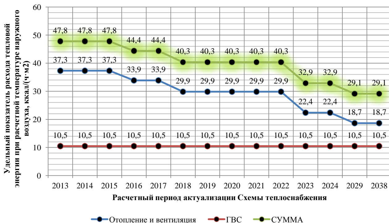
Рисунок 1-1 - Изменение нормируемого удельного расхода тепловой энергии на отопление, вентиляцию и ГВС на примере жилого 12-этажного многоквартирного дома
