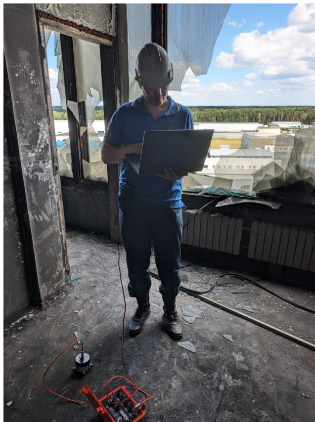
Фотография 7.2 – Место сбора данных при динамических испытаниях здания
